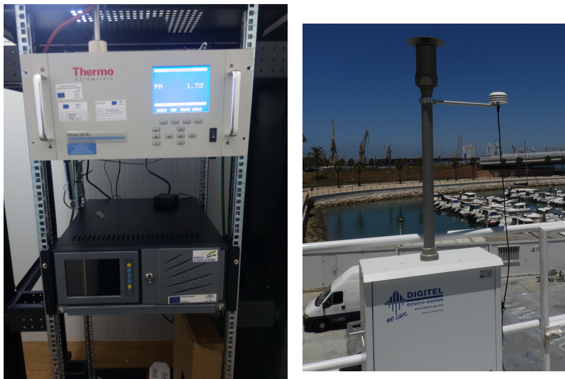
Figura 2.4.- Equipo de atenuación beta (Thermo) para la medida en continuo de PM10 con integrador de datos (izquierda) y captador de bajo volumen DIGITEL para el muestreo de partículas PM10.
