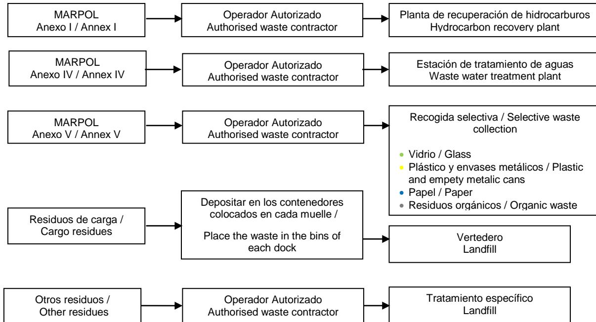
El buque deberá entregar los residuos Marpol I y IV debidamente segregados y mantendrá los residuos en los tanques destinados a su almacenamiento. Así mismo, deberá contar con los medios técnicos adecuados para su entrega: conexiones, bridas y bombas, coincidiendo todo ello con lo establecido en el anexo I del Convenio Marpol 73/78 (Reglas 18 y 19) y sus enmiendas, así como con lo establecido en su certificado IOPP.
