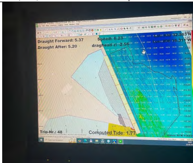
Figuras 07: Monitor del multihaz con la zona de dragado, las profundidades y la posición de la draga en la zona frente de cajones de la NTC. Tras la segunda carga. Figura 08 y 09. Supervisión del cabezal al finalizar la segunda carga. Resultado negativo.
