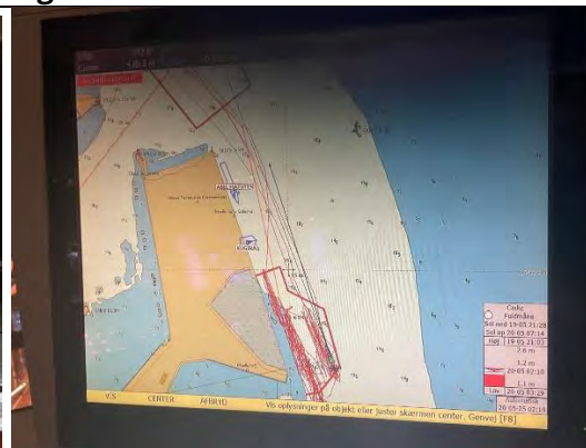
Figuras 06: Monitor del multihaz con la zona de dragado, las profundidades y la posición de la draga en la zona frente de cajones de la NTC. Tras la primera carga. Figura 07. Supervisión del cabezal al finalizar la primera carga con material de deshecho compuesto por cabos. Resultado negativo. Figura 08: Monitor con los tracks sobre la zona de dragado.
