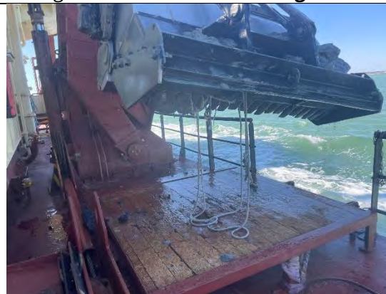
Figuras 07: Monitor del multihaz con la zona de dragado, las profundidades y la posición de la draga en la zona frente de cajones de la NTC. Tras la primera carga. Figura 08 y 09. Supervisión del cabezal al finalizar la segunda carga, encontrando sobre el propio cabezal un lingote de hierro, un cuerno de bovino, además de material de desecho compuesto por cabos. Figura 08: Monitor con los tracks sobre la zona de dragado.
