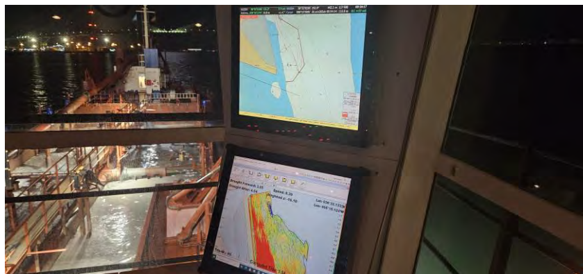
Figura 07 - Seguimiento y control arqueológico de la Fase II de la ampliación de la NTC, a bordo de la Idun R Supervisión de las labores de dragado, trazado, tipo de sedimento,.. Monitor del multihaz con la zona de dragado, las profundidades y la posición de la draga en la zona frente de cajones de la NTC, durante la segunda y última carga completada en el turno.
