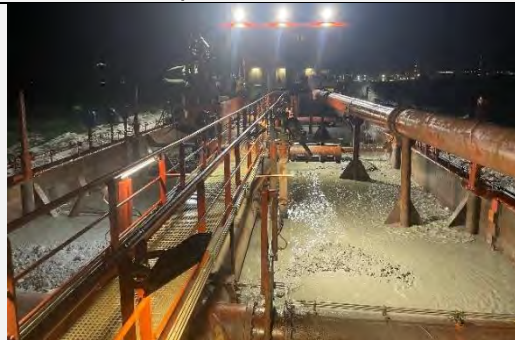
Figuras 05, 06 y 07 – Seguimiento y control arqueológico de la Fase II del dragado de profundización del frente de cajones de la Nueva Terminal de Contenedores (NTC) a bordo de IDUN R. Supervisión de la cántara tras la 2ª carga completada en el turno de noche y revisión de la limpieza del cabezal, con material de desecho, principalmente cabos. Resultado negativo.
