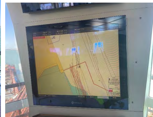
Figuras 07: Monitor del multihaz con la zona de dragado, las profundidades y la posición de la draga en la zona frente de cajones de la NTC. Tras la primera carga. Figura 08 y 09. Supervisión del cabezal al finalizar la segunda carga, encontrando sobre el propio cabezal un lingote de hierro, un cuerno de bovino, además de material de desecho compuesto por cabos. Figura 08: Monitor con los tracks sobre la zona de dragado.
