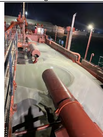
Figuras 013,014 y 015: – Seguimiento y control arqueológico de la Fase II del dragado de la Nueva Terminal de Contenedores (NTC) a bordo de VIKING R. Supervisión de la cántara tras la 4ª carga completada en el turno de noche. Figura 016: Revisión del cabezal tras la carga. Resultado: Dos fragmentos de madera con unas medidas aproximadas de 60 x 20 cm, atascados en la parte baja de la cabeza de succión.
